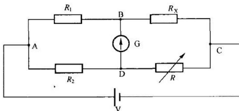
图 1 两端式电桥节点位置
