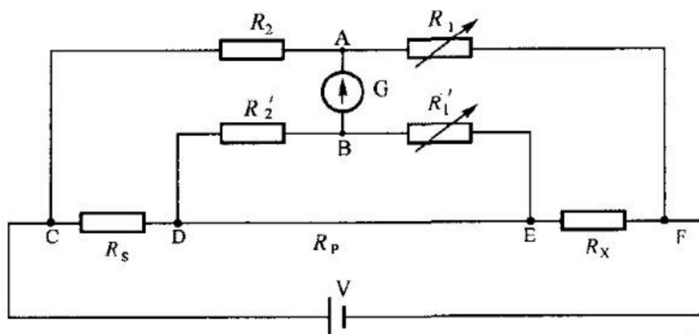
图 2 四端式电桥节点位置
