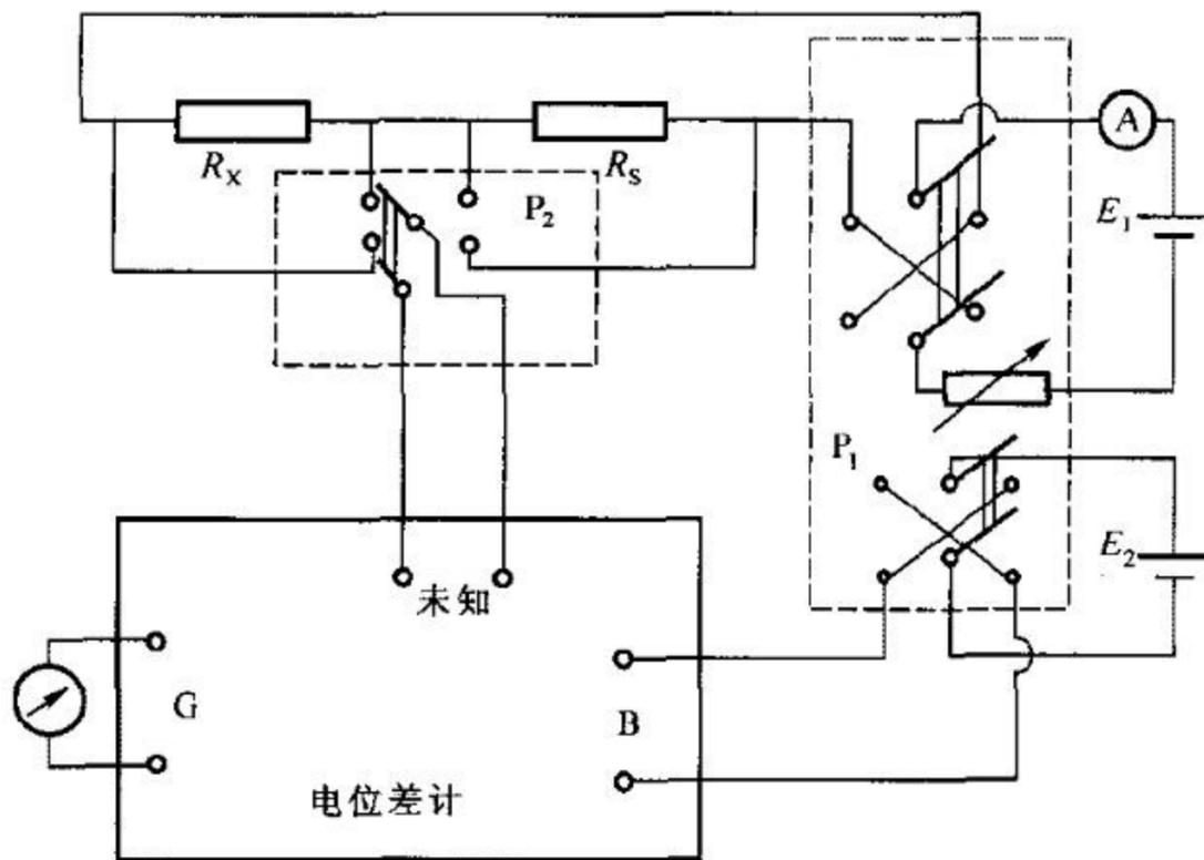
图 D1 电位差计测量电阻原理图
