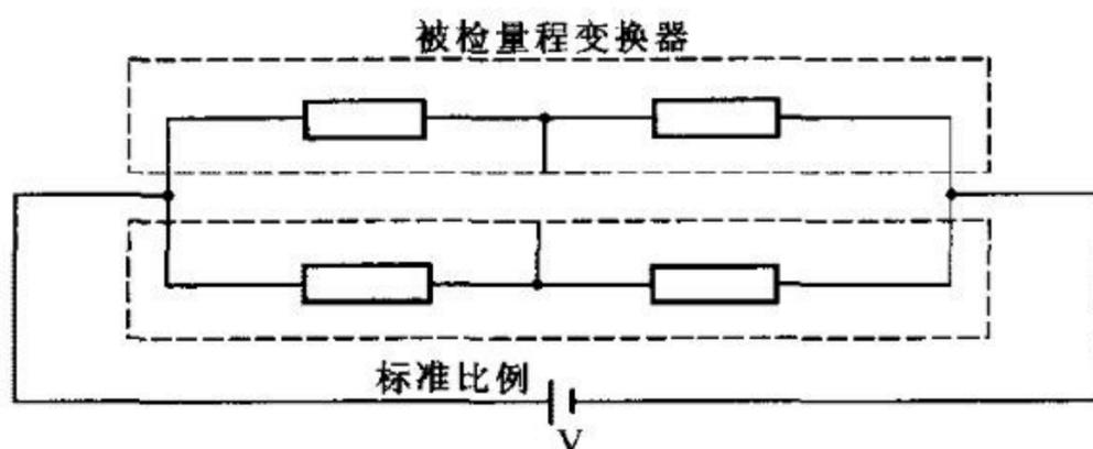
图 4 量程变换器整体检定
