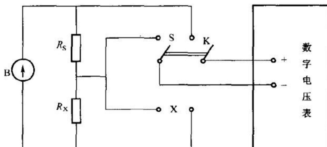
图 C1 恒流源、数字电压表测量电阻原理图
