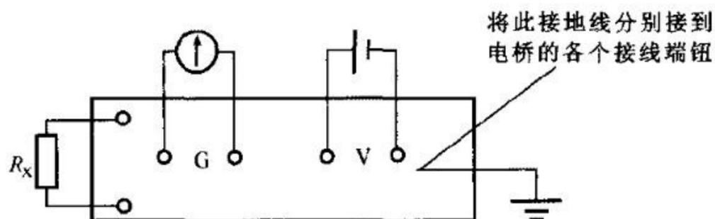
图3 电桥绝缘电阻对整体误差影响试验
